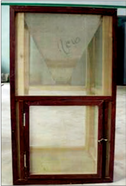
Light Trap for insect catching ပုံ (၃)
