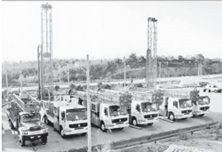
တရုတ်ပြည်သူ့သမ္မတနိုင်ငံမှ ထုတ်လုပ်သော မြေအောက်ရေရရှိရေးလုပ်ငန်းတွင် အသုံးပြုသည့် RG တွင်းတူးစက်အသစ်များကို တွေ့ရစဉ်။
