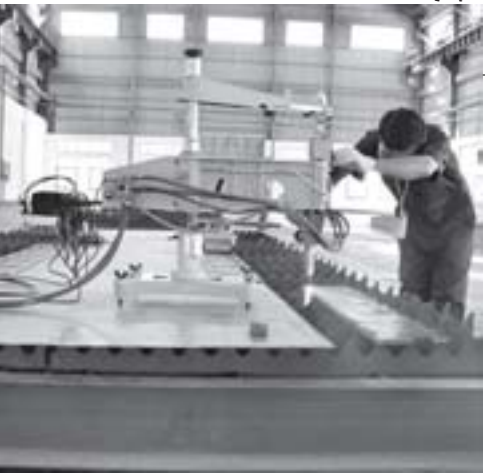
ဂျင်နရေတာထုတ်လုပ်မှုအပိုင်းအတွက် လိုအပ်သော သံမဏိ ပါးလွှာ ပြားများကို ဤသို့ ခေတ်မီစက်ကြီးဖြင့် Coating ပြုလုပ်ပေးသည်။ (မြန်မာ့အလင်း)
