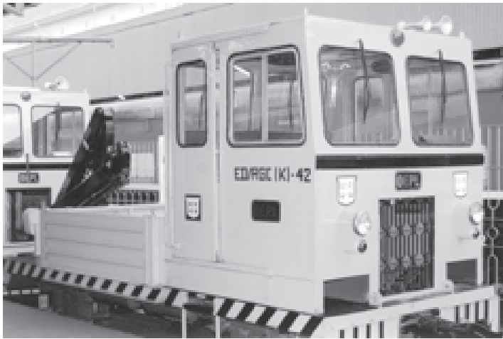
အိန္ဒိယသမ္မတနိုင်ငံမှ ဝယ်ယူတင်သွင်းခဲ့သော ဝန်ချီစက်အင်ယ်စားပါ သံလမ်းပြုပြင်ထိန်းသိမ်းရေးအဖွဲ့ လိုက်ပါနိုင်သည့် ကွန်ပျူတာစနစ်သုံး သံလမ်းပြေးယာဉ် (Rail Gang Car with Crane) ကို ဤသို့ တွေ့ရသည်။ (သတင်းစဉ်)
