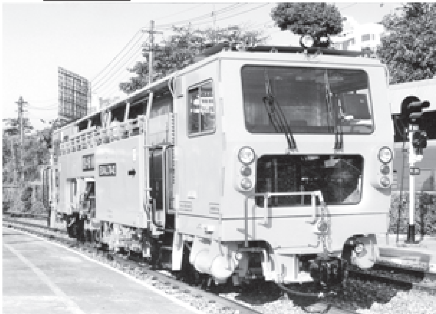
အိန္ဒိယသမ္မတနိုင်ငံမှ ဝယ်ယူတင်သွင်းခဲ့သော အလိုအလျောက် လမ်းညှိ လမ်းပြုပြင်သည့် ကွန်ပျူတာစနစ်သုံး စက်ယန္တရား (Automatic Levelling, Lining & Tamping Machine) ကို ဤသို့ တွေ့ရသည်။ (သတင်းစဉ်)
