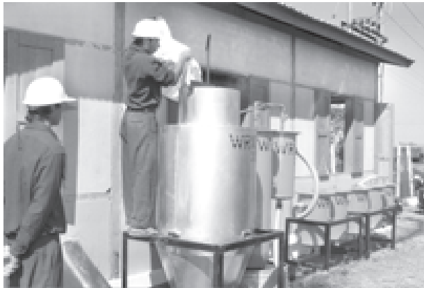
ဘားလား(၂) မဲပြလယ်ယာ လျှပ်စစ်ရောင်စီမံကိန်းတွင် စပါးခွံ ဓာတ်ငွေ့လောင်စာပြုလုပ်သည့် လောင်ကန်အတွင်းသို့ စပါးခွံလောင်စာ ထည့်သွင်းနေမှုကို ဤသို့ တွေ့ရသည်။
