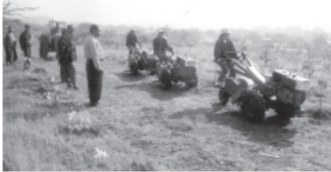
ကြက်ဆူဆီဖြင့် လက်တွန်းထွန်းစက် မောင်းနှင်ပြသနေစဉ်။
