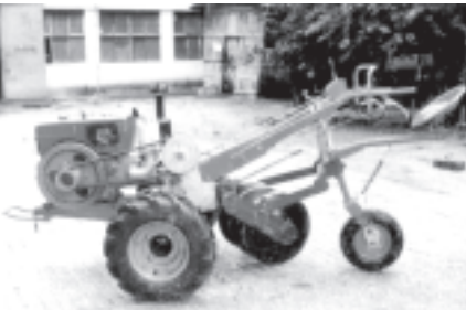
အမှတ်(၂)စက်မှု ဝန်ကြီးဌာန မြန်မာ့လယ်ယာသုံး စက်ပစ္စည်း ထုတ်လုပ်မှုလုပ်ငန်း လယ်ယာသုံး စက်ပစ္စည်း ထုတ်လုပ်မှုစက်ရုံမှ ထုတ်လုပ်သော ရော(၁) လက်ကွန်းလယ်ထွန်စက်။
