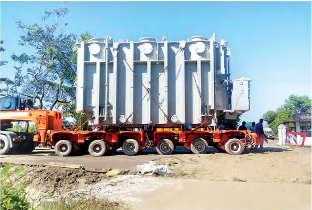
ကျိုက်လတ်ဓာတ်အားခွဲရုံသို့ ရောက်ရှိလာသော ၂၃၀ ကေစီ ထရန်စဖော်မာများကို တွေ့ရစဉ်။ (ဓာတ်ပုံ-လျှပ်စစ်)
