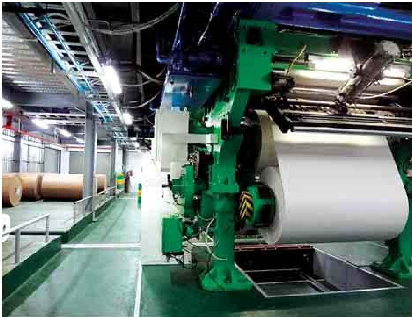
The Global New Light of Myanmar သတင်းစာ စက်ရုံသစ်၌ တပ်ဆင်ထားသည့် ဂျပန်နိုင်ငံထုတ် Mitsubishi Lithopia 4 Hi Tower 3 Unit Offset အမျိုးအစားပုံနှိပ်စက်ကို တွေ့ရစဉ်။ (သတင်း - စာမျက်နှာ ၈)
