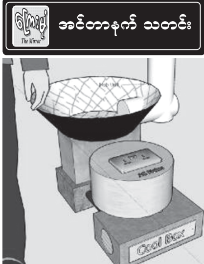
၁- Hot heat exchanger (engine) ၂- Cold heat exchanger (engine) ၃- Cold heat exchanger (cooler) ၄- Hot heat exchanger (cooler) ချက်ပြုတ်ခြင်း၊ အအေးခံခြင်း နှင့် လျှပ်စစ်ဓာတ်အား ထုတ်လုပ် ပေးခြင်းတို့ ပြုလုပ်ပေးနိုင်သော SCORE မီးဖိုကို တွေ့ရစဉ်။ (ဓာတ်ပုံ-အင်တာနက်)
