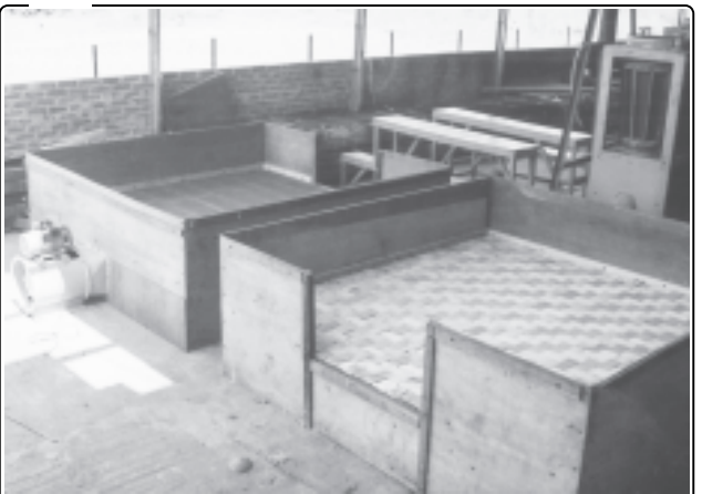
စပါးနှင့် သီးနှံများအခြောက်ခံရာတွင် အသုံးပြုသော ပြည်တွင်းဖြစ် စပါးလှောင်ကန်ဖြင့် အသုတ်လိုက် အခြောက်ခံစက် (Flat Bed Dryer) ကို တွေ့ရစဉ်။
