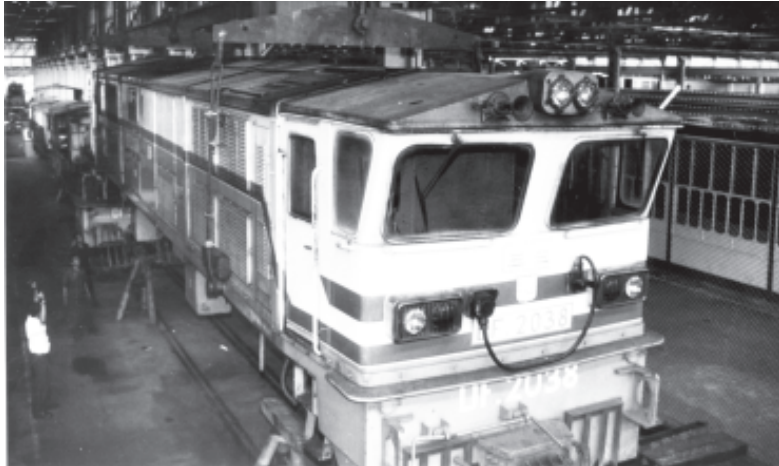
အင်းစိန် စက်ခေါင်းစက်ရုံတွင် ဒီဇယ်လျှပ်စစ်စက်ခေါင်းကြီးများ အကြီးစားပြုပြင်ခြင်းလုပ်ငန်းများ ဆောင်ရွက်ရန် ရောက်ရှိလာသော စက်ခေါင်းကြီးကို ဝန်ချိစက်ကြီးဖြင့် သယ်ယူ၍ အလုပ်ရုံအတွင်း ပို့ပေးနေသည့်ကို ဤသို့ တွေ့ရသည်။ (ဓာတ်ပုံမှတ်တမ်း-ရေချမ်းမြင့်)
